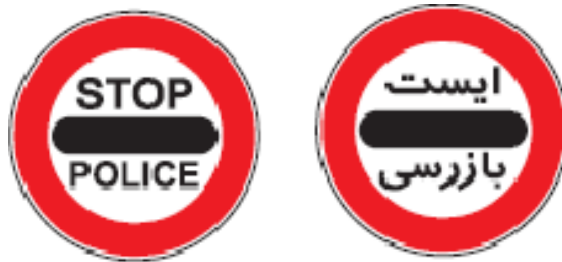
شکل ۳۶ - تابلوهای عبور بدون توقف ممنوع
