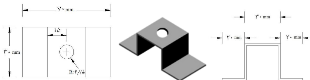
شکل پ ۴ - نمایی از بست زیرسری به پشت صفحه‌ی تابلو
